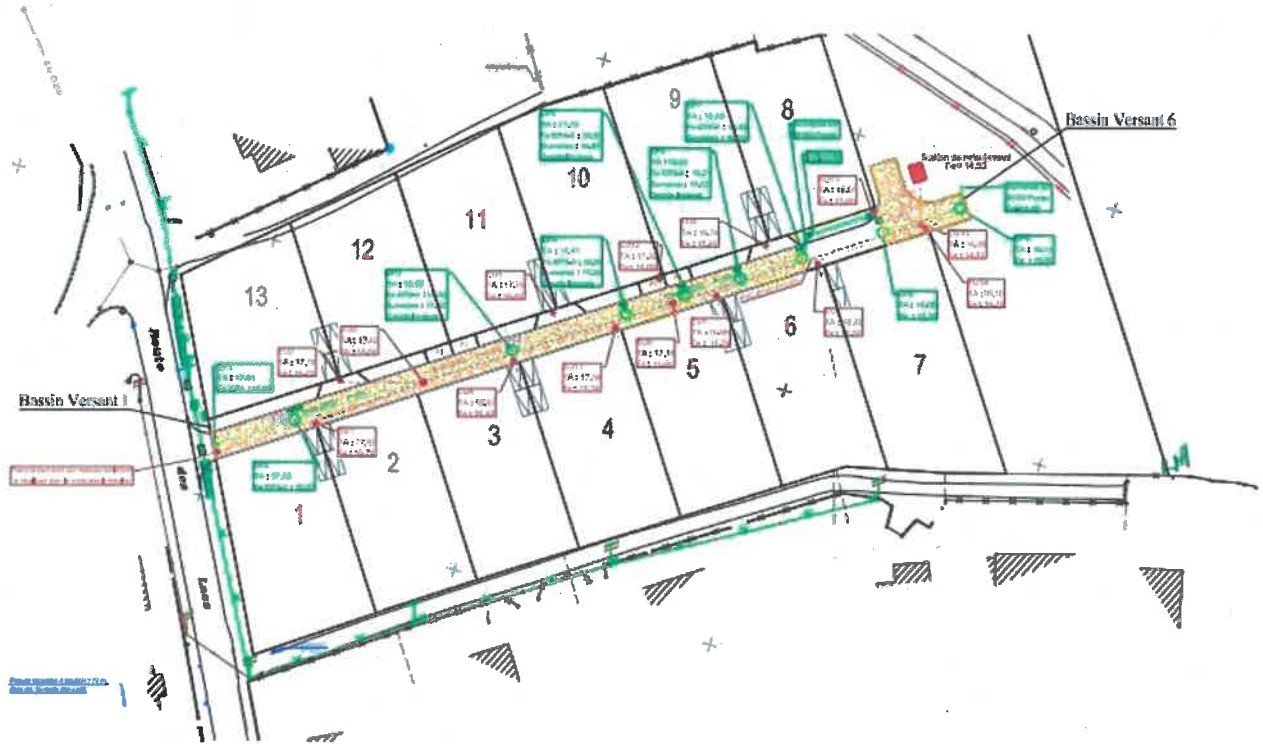
Figure 8 : Plan du système d'assainissement des eaux pluviales
